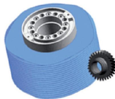
**Fig. 1 – Rettificazione a generazione continua con mola a vite.**
