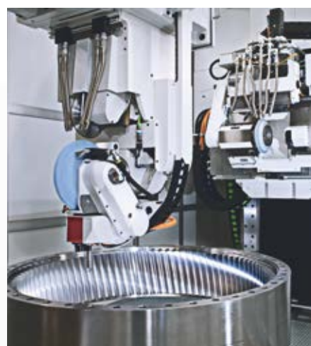
ZP E/I con cambio tra lavorazione esterna ed interna senza attrezzaggio
