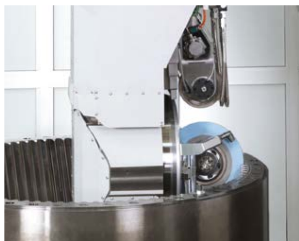
ZP I/E con braccio di rettifica velocemente reversibile per la lavorazione di dentature interne ed esterne di grande modulo
