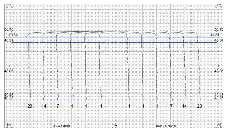
Misurazione del profilo e elica / rettificazione topologica a vite
