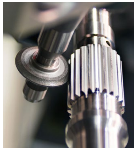
Außen-, Innen-, Gerad- und Schrägverzahnungen sowie Sonderprofile
