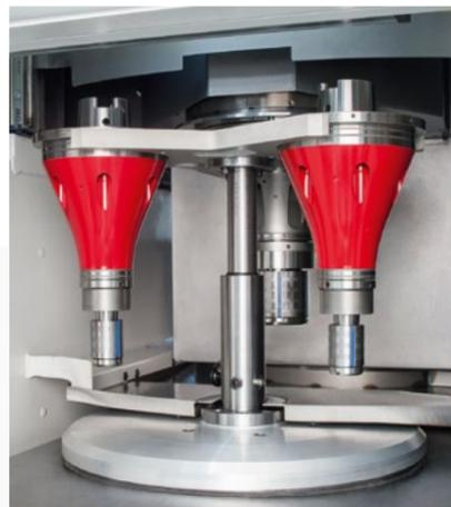
Multifunktionsachse zum Ausschleusen von Mess- und Prüfteilen
