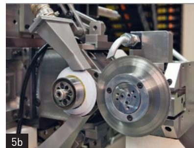
perti di diamante sintetico. La precisione del profilo, a seconda dell'applicazione, è nel campo dei 2 micron. il modulo può essere minore di 1 mm.
