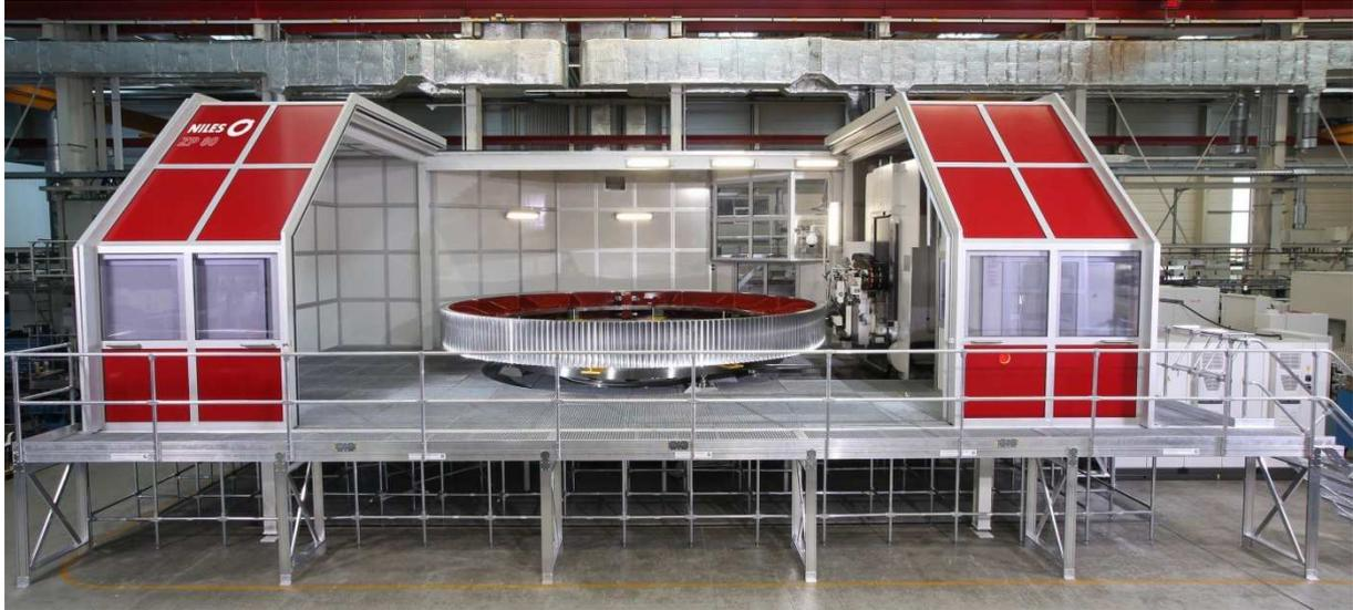
Foto 1 Niles ZP 80 con ruota dentata di mulino costruita da Fachini Gears spa
