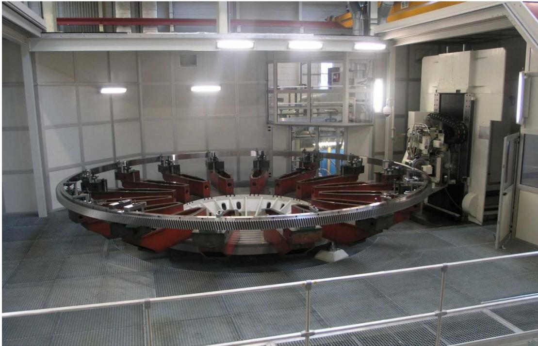
Foto 3 Niles ZP 80 con ruota dentata di azionamento tavola di macchina utensile
