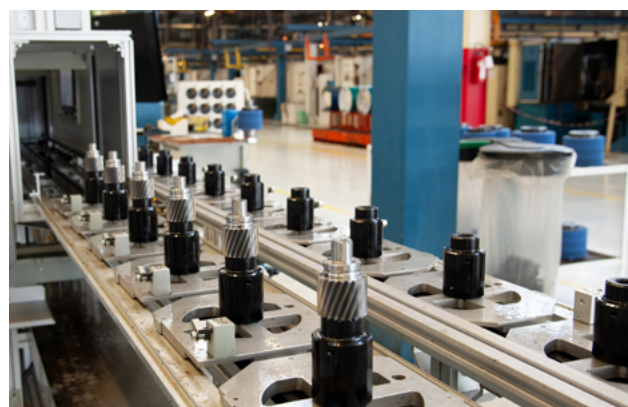
Figura 3: Avanzamento automatico del pezzo
