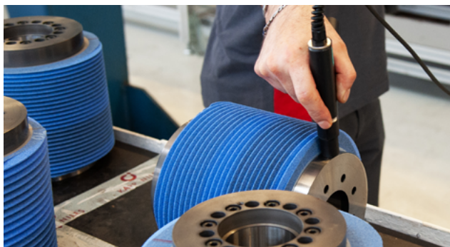
Figura 5: Grazie al riconoscimento RFID gli utensili e gli accessori possono essere facilmente e chiaramente identificati
