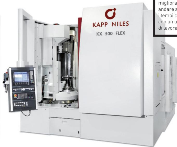
Kapp KX 500 Flex rettificatrice a generazione a vite e a profilo per ingranaggi fino a modulo 10 con diametri fino a 500 mm.
