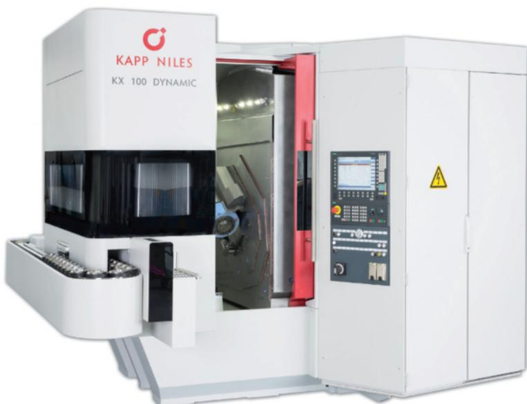
Kapp KX 100 Dynamic rettificatrice a generazione a vite con 2 mandrini portapezzo per ingranaggi fino a modulo 3 con diametri fino a 120 mm.
