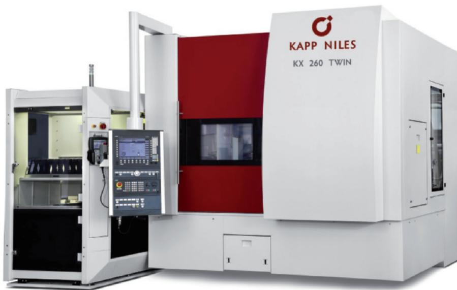
Kapp KX 260 Twin rettificatrice a generazione a vite e a profilo con 2 tavole portapezzo per ingranaggi fino a modulo 5 con diametri 260 mm.
