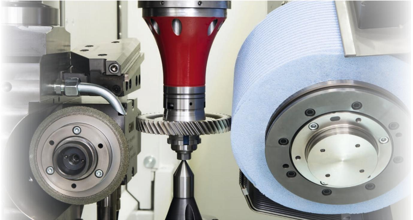
Wir bieten Ihnen Abrichtrollen zum flexiblen, werkstückgebundenen oder topologischen Abrichten von keramisch gebundenen Korund- oder CBN-Werkzeugen für **das kontinuierliche Wälzschleifen** von Außenverzahnungen.
