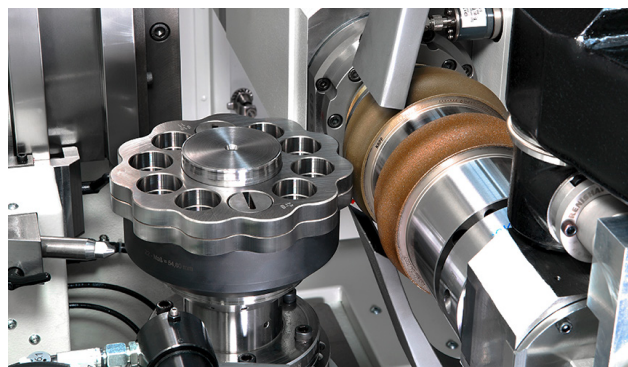
Bild 1: Außen-Zykloidbearbeitung auf dem KAPP NILES-Verzahnungszentrum KX 300 P © KAPP NILES
