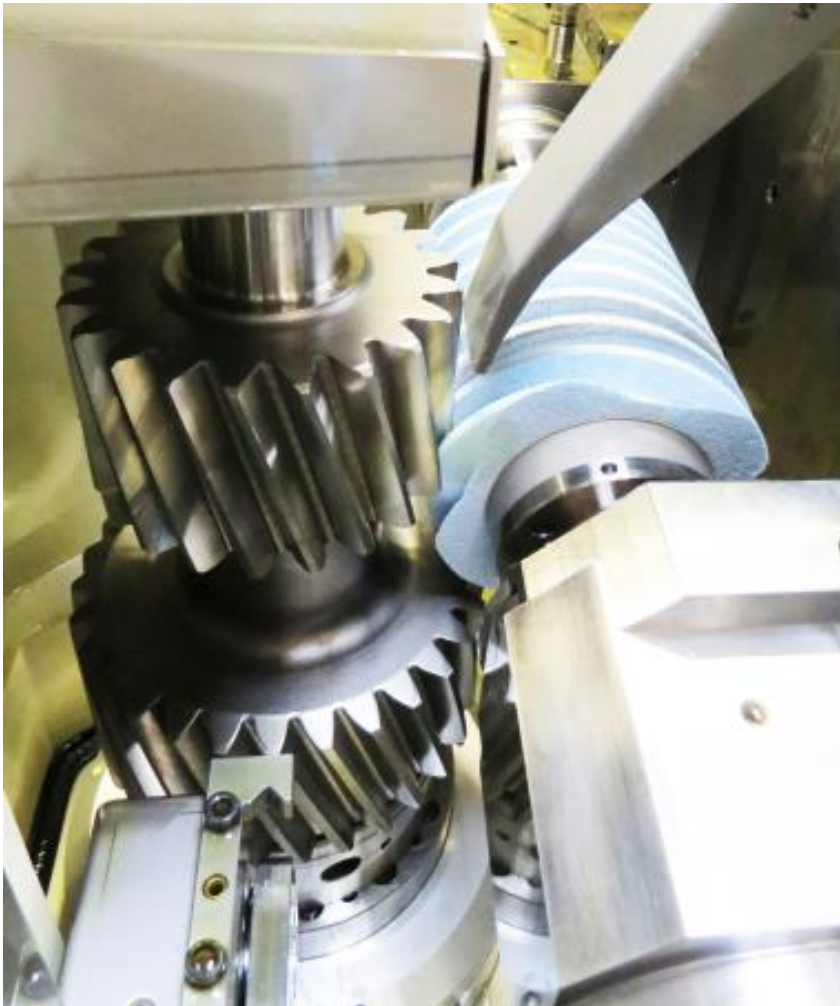
Bild 1: Wälzschleifen eines Zahnrades mit Störkontur, in diesem Fall ein benachbartes Zahnrad
