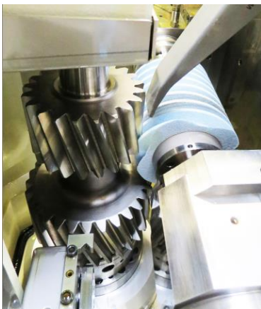
Bild 1: Wälzschleifen eines Zahnrades mit Störkontur, hier ein benachbartes Zahnrad
