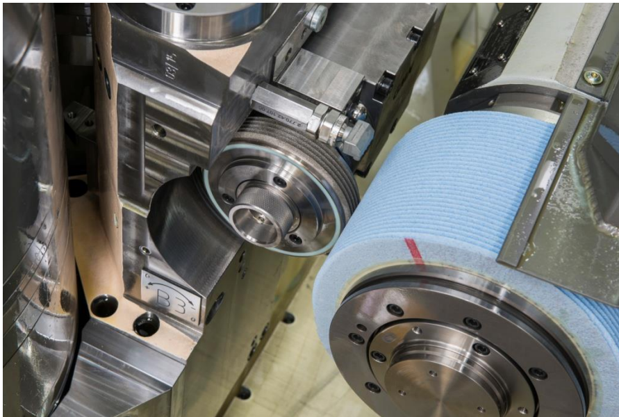
Bild 6: Mehrmilliges Abrichten einer Korundschncke spart Zeit
