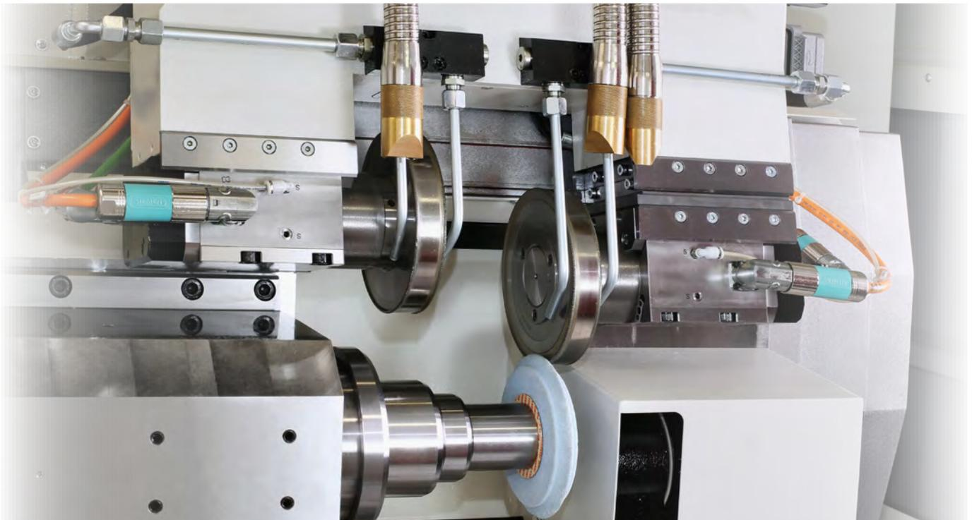
Wir bieten Ihnen Abrichtrollen zum Profilieren von abrichtbaren Profilschleifscheiben in unterschiedlichen Ausführungen, sowohl mit einfachem als auch mit beidseitigem Radius.
